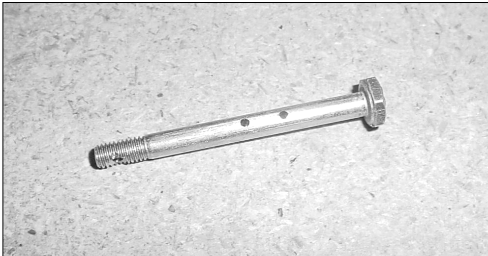
AN3-20 Bolt on Bell Crank 7E5-1.
