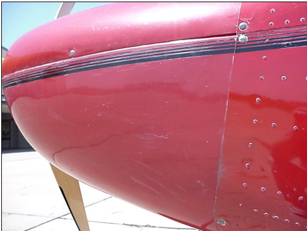
4 Dzus fasteners per side
